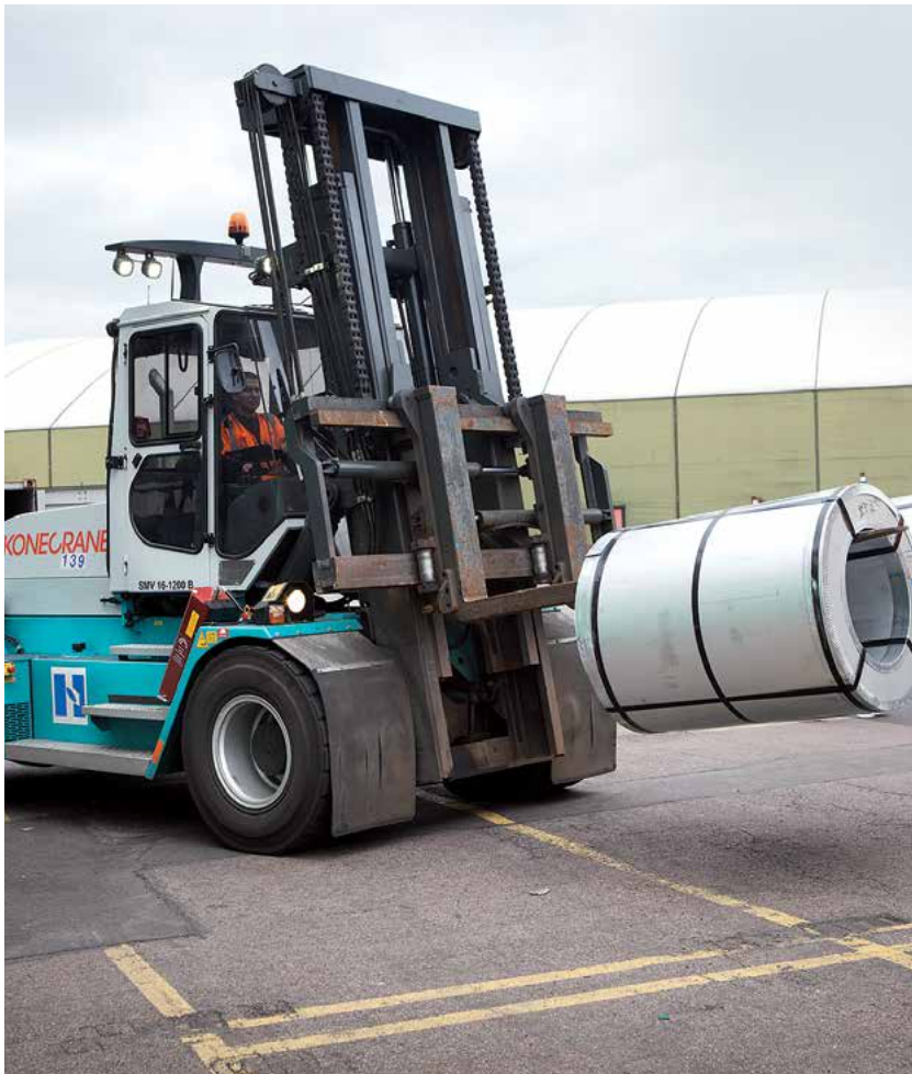
Ричстакер SMV 4545 CBX5 грузоподъемностью 45 тонн может обрабатывать грузы с трех железнодорожных путей.
